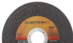
Mineral Cubitron™ II · Tecnología 3M PSG, para cortes muy rápidos, fríos y mayor vida útil del disco · Tipo 42 (centro hundido) · Resultados óptimos a bajas presiones de trabajo · Válido tanto para aceros al carbono como inoxidables
