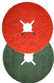
Mineral Cubitron™ II · Soporte de fibra · Con aditivo refrigerante · Aplicaciones: Amolado de soldadura, eliminación de material base y homogeneización de superficies. Biselado de piezas. Se recomienda exclusivamente trabajar en superficies planas · Para los granos 60+, 80+ y 120+ se utiliza preferentemente el plato rojo liso según medida (PN64857, 64858 y 64859) · Para el grano 36+ se recomienda utilizar el plato rojo duro (estriado según medida (64860, 64861 y 64862)
