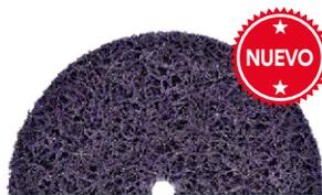
Mineral de Carburo de Silicio · Grano S Extra Basto · Ideal para eliminar restos de pintura sin afectar al metal base, eliminar calamina entre otras aplicaciones
